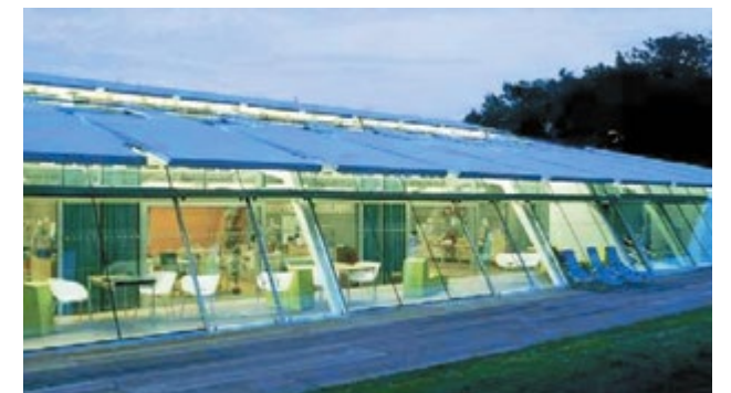
Рисунок 83 — «Теплица» (застекленная галерея для ковокинга или отдыха) на южной стороне здания, на крыше — скользящие панели, которые передвигаются по необходимости, чтобы уменьшить яркий солнечный свет
